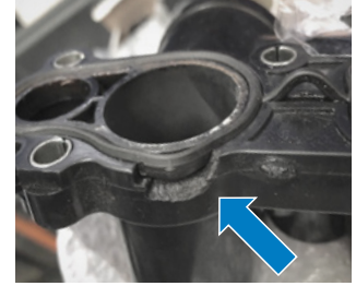
Şek. 3: Kırılma (hasar belirtisi)
