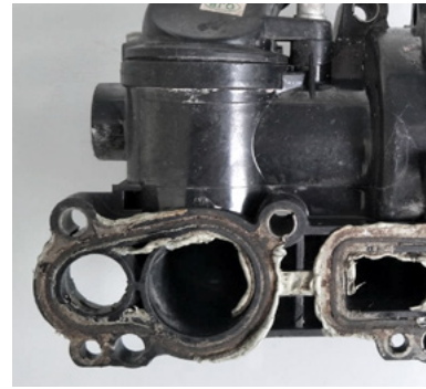
Şek. 5: İlave sızdırmazlık maddesi nedeniyle sızdırma (hasar belirtisi)
