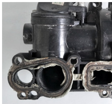
Rys. 5: Nieszczelności wskutek zastosowania dodatkowych środków uszczelniających (obraz uszkodzenia)
