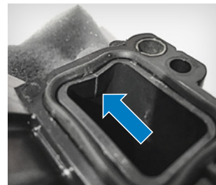
Fig. 2: Rottura (tipologia di danno)
