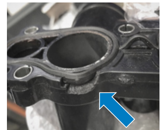
Fig. 3: Rottura (tipologia di danno)
