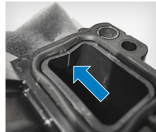
2. ábra: Törés (kárhelyzet)
