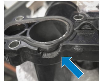
3. ábra: Törés (kárhelyzet)
