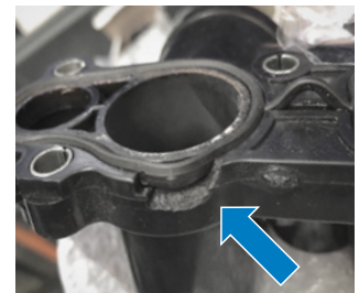
Fig. 3 : Cassure (vue du dommage)
