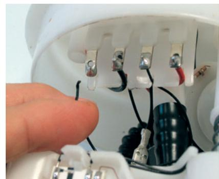
Fig. 3: Tipologia di danno: Il cavo del trasduttore livello carburante è allentato e i contatti sono piegati.
