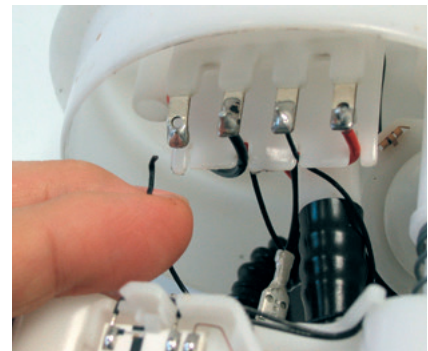
Fig. 3 : dommage typique : le câble de l'indicateur de niveau est débranché et les contacts électriques sont déformés.
