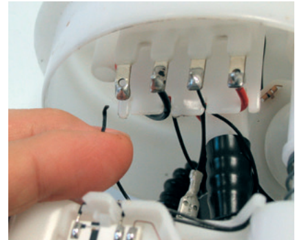
Şek. 3: Tipik hasar belirtisi: Depo sensörünün kablosu gevşemiş ve elektrikli kontak tırnakları bükülmüş.
