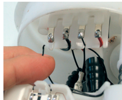
Fig. 3: Imagem de danos típica: o cabo do sensor do depósito está solto e as lâminas de contato elétrica estão empenadas.
