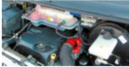
Iveco Daily 3.0 I motor bölmesindeki ayar klapesi (kırmızı vurgulanmıştır)
