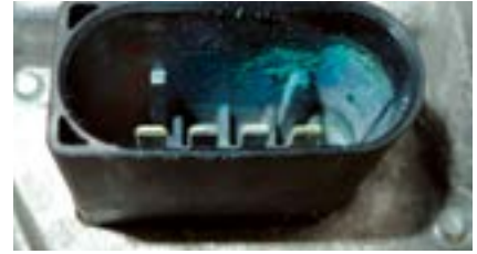
Korozyon izleri olan montaj soketi
