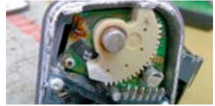
Hasarlı bir ayar klapesinin içten görünümü
