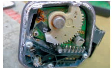
Pohled dovnitř poškozené regulační klapky
