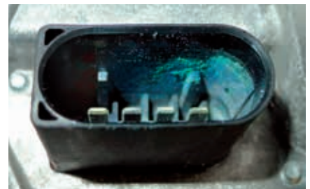
Vestavěný konektor se stopami koroze
