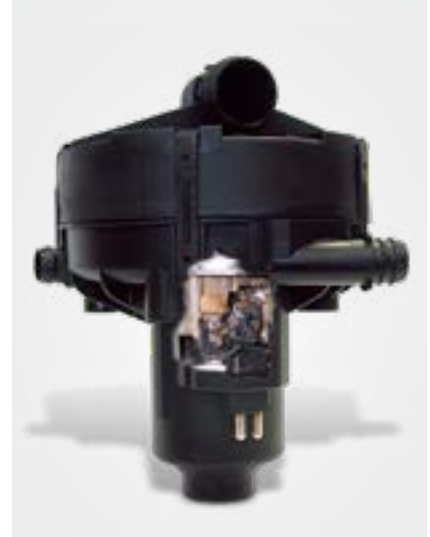
Eriye izlerinin olduęu sekonder hava pompasına yakından bakış (kesit)
