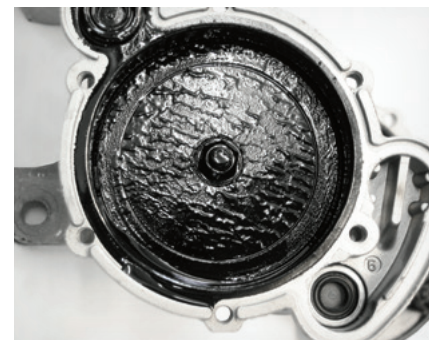
Рис. 3. Масляный шлам в вакуумном насосе VW Transporter, приводящий к появлению стука
