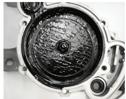
3. ábra: A vákuumszivattyúban lerakódott olajiszap a VW Transporter-ben csattogó hangokat kelt
