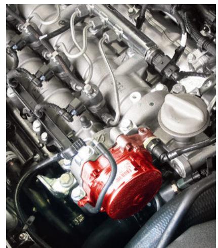
Вакуумный насос в автомобиле Opel Vectra C (выделен цветом)
