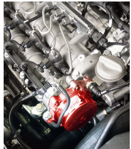
Pompe à vide installée dans une Opel Vectra C (en rouge)
