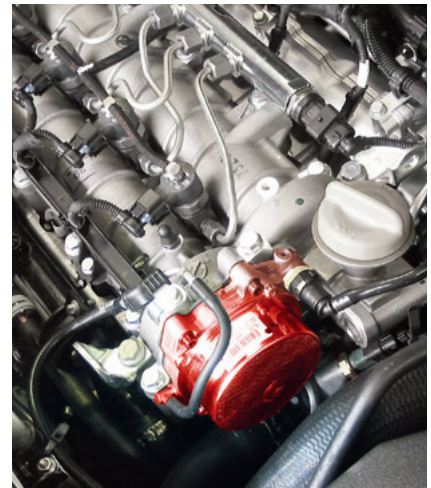
欧宝威达 C (Opel Vectra C) 中的真空泵 (高亮显示)
