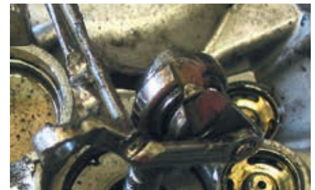
Imaginea deteriorării: culbutorul distrus complet
