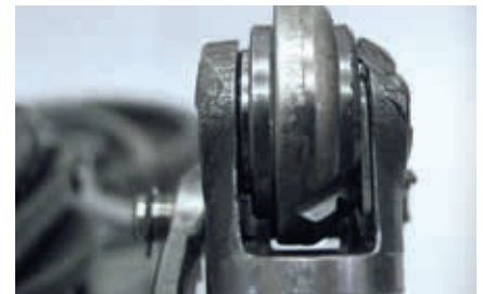
Kárhelyzet: egyoldalúan elkopott futógörgő
