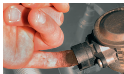
„Proba cu degetul” efectuată la supapa de aer secundar dintr-un BMW 520i (evidențiat) Dacă pe această parte sunt depuneri, înseamnă că supapa de sens unic este neetanșă și trebuie înlocuită.
