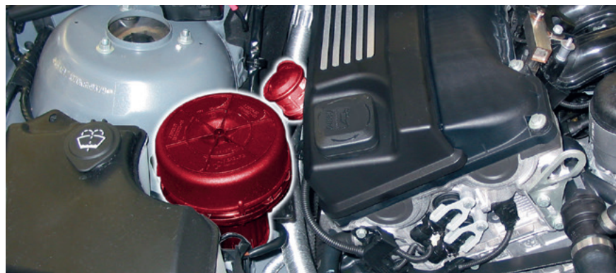
Supapa de aer secundar și pompa de aer secundar la BMW E46 (evidențiat)
