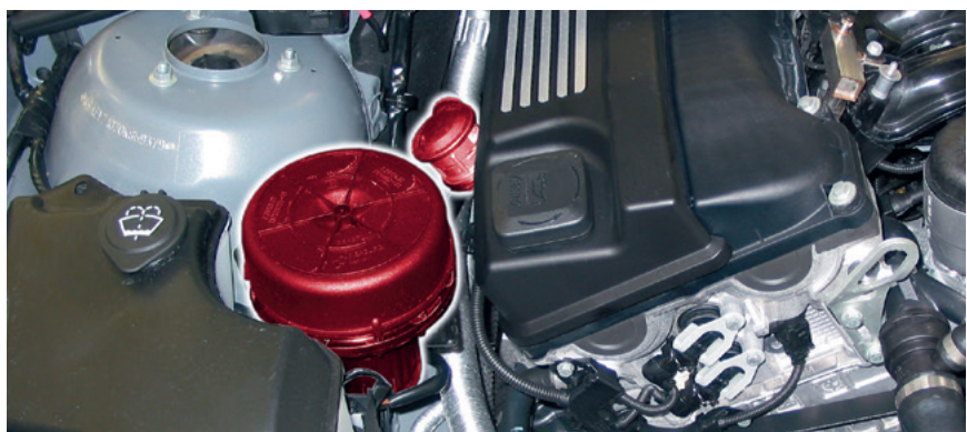
Válvula de ar secundário e bomba de ar secundário no BMW E46 (destacadas)
