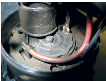
Condensação de gases de escape agressiva no motor de accionamento de uma bomba de ar secundário
