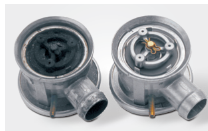
Válvula de ar secundário aberta À esquerda: danos causados pela condensação de gases de escape à direita: Estado novo
