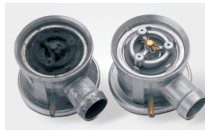
Otwarty zawór powietrza wtórnego z lewej: uszkodzenia spowodowane działaniem kondensatu spalin Z prawej: stan fabryczny
