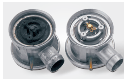
Geopende secundaireluchtklep links: Schade door uitlaatgascondensaat rechts: Nieuwe toestand
