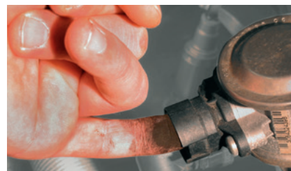
"Vingertest" op de secundaireluchtklep in de BMW 520i (geaccentueerd) Als aan deze kant afzettingen aanwezig zijn, is de terugslagklep ondicht en moet deze worden vervangen.
