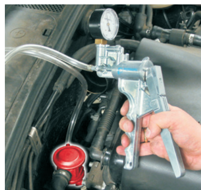
Szekunderlevegő-szelep ellenőrzése vákuumszivattyúval
