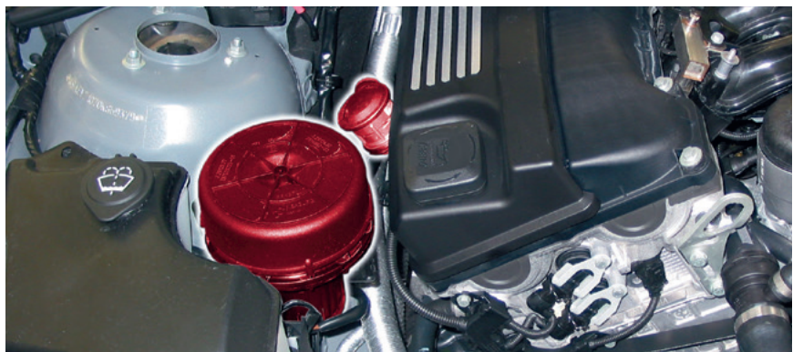
Szekunderlevegő-szelep és szekunderlevegő-szivattyú egy BMW E46-ban (kiemelve)
