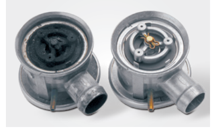
Açık sekonder hava supabı sol: Egzoz gazı yoğunluğundan kaynaklı hasarlar sağ: Yeni durum
