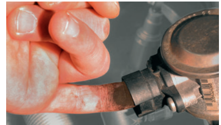
BMW 520i modelindeki sekonder hava supabında "parmak ile örnek alma" (vurgulanmıştır) Bu tarafta tortulanmalar mevcutsa çekvalf sızdırıyordu ve değiştirilmesi gerekir.
