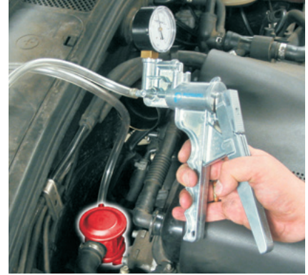
Sekonder hava supabının bir manuel vakum pompası ile kontrol edilmesi
