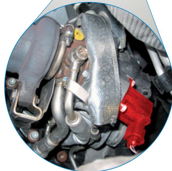
Válvula de desvio de ar no VW EOS TFSI (destacada a vermelho)
