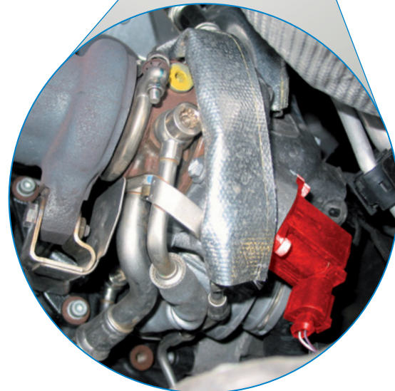
Zawór recyrkulacji powietrza w VW EOS TFSI (zaznaczony na czerwono)
