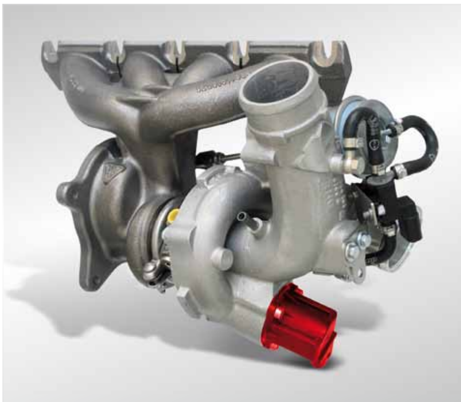
Visszakeringető szelep (kiemelve) egy Audi A3 2.0 TFSI turbófeltöltőjére szerelve
