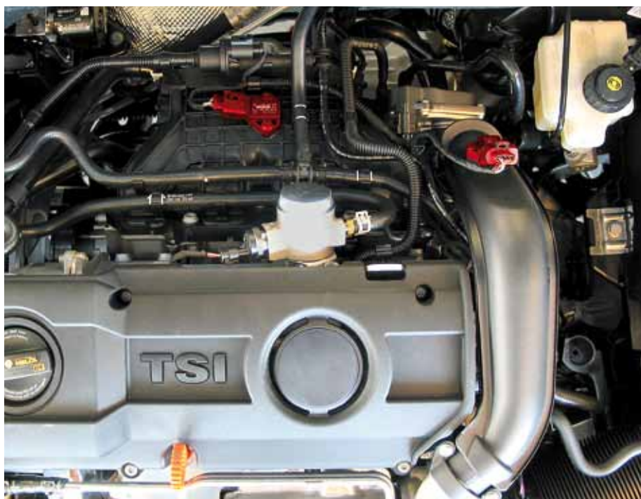
Insugningsrörets tryckgivare (till vänster) och laddtrycksgivaren (till höger) i VW Golf VI (rödmarkerade)
