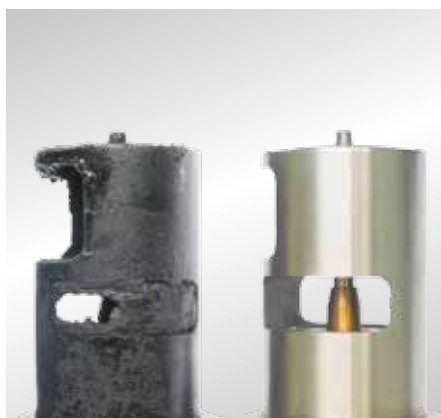
Eftersom EGR-ventiler inte kan sotas ner av sig själva, måste man söka efter orsakerna för sotet.
