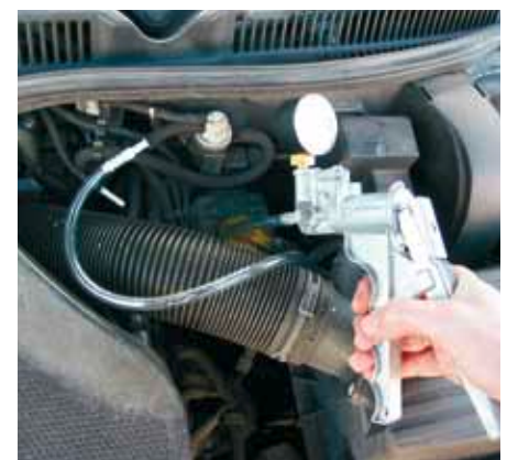
Și în cazul supapelor AGR, și la sistemele cu traductor electro-pneumatic (EPW), ca de exemplu cel de față: funcționalitatea se poate verifica ușor cu pompa manuală de vid.
