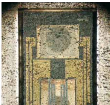
A só és a szennyeződés a légtömeg-érzékelő szenzorát károsíthatja, de legalábbis meghamisíthatja a mérési eredményeket, ami úgyszintén kihat az EGR működésére.
