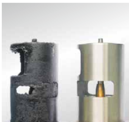
Mivel az EGR szelepek maguktól nem kormozódnak, a kormozódás okát ki kell deríteni.
