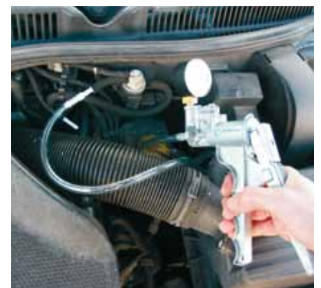
Είτε πρόκειται για πνευματικές βαλβίδες EGR είτε όπως εδώ για μία EPW: η λειτουργία μπορεί να ελεγχθεί εύκολα με μία χειραντλία κενού.
