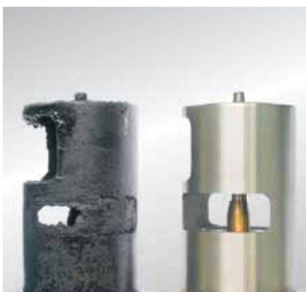
Καθώς οι βαλβίδες EGR δεν μπορούν να γεμίσουν αιθάλη μόνες τους, πρέπει να αναζητηθεί η αιτία της συσσώρευσης αιθάλης.
