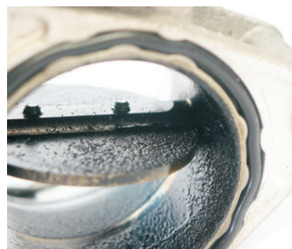
Regulační klapka trpící znečištěním olejem
