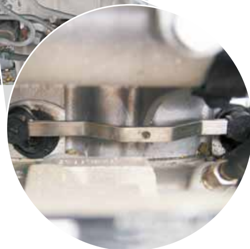
Система тяг на впускном коллекторе в Opel Vectra (сверху выделена красным цветом и вид детали)
