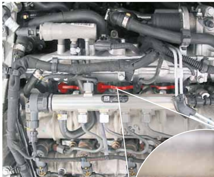
Tirante da caixa de velocidades no tubo de aspiração no Opel Vectra (destacado a vermelho em cima e com vista detalhada)
