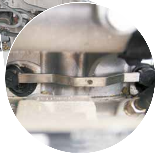
Tirante da caixa de velocidades no tubo de aspiração no Opel Vectra (destacado a vermelho em cima e com vista detalhada)
