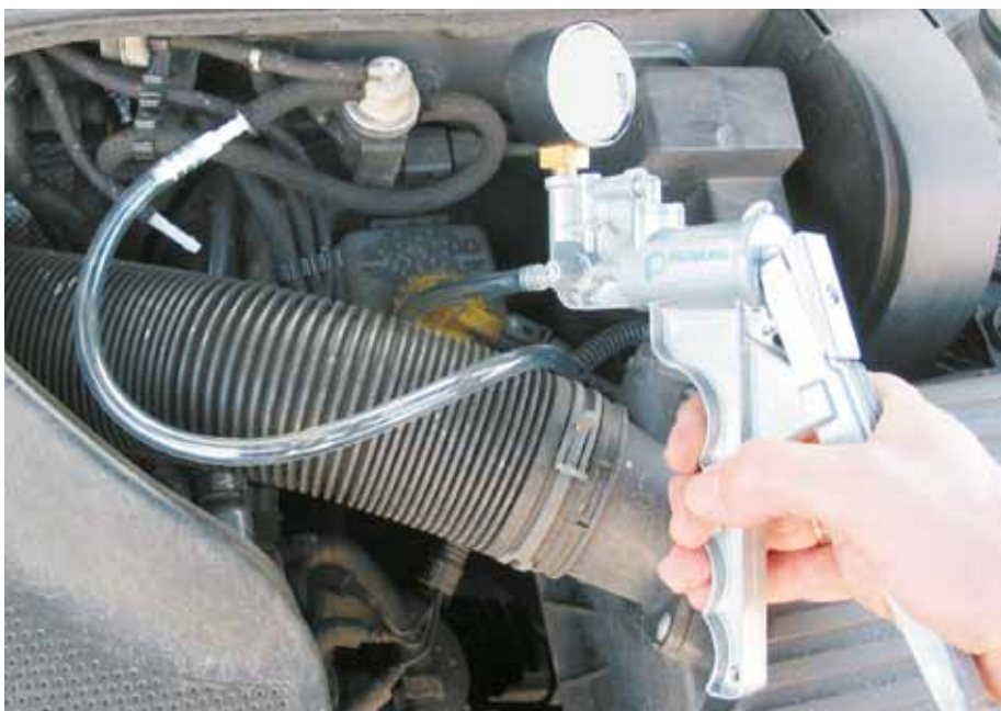
Kontroll av en EPW med handvakuumpumpen (VW Golf IV)
