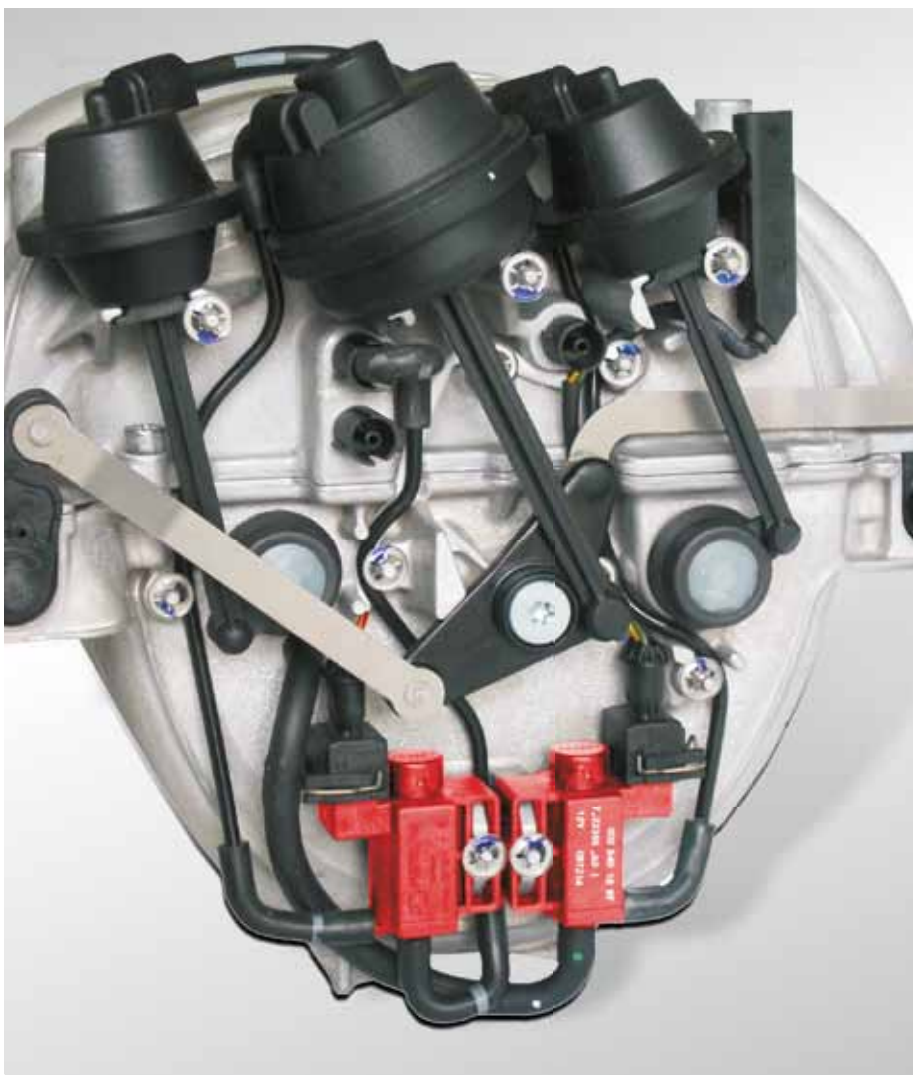
Toepassingsvoorbeeld: zuigpijp met elektropneumatische kleppen (rood geaccentueerd) in de Mercedes C-klasse
