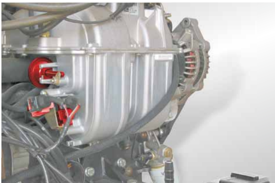
Op de schakelzuigpijp in de Opel Astra zijn direct twee EUV aangebracht (rood geaccentueerd). De ene bestuurt via de erboven liggende drukdoos (rood geaccentueerd) de zuigpijpleppen; de andere schakelt de secundaire uitschakelklep (niet afgebeeld).
