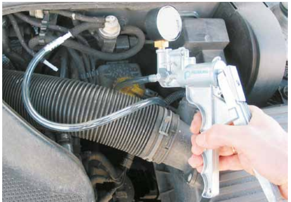
Controle van een EPW met de handonderdrukpomp (VW Golf IV)
