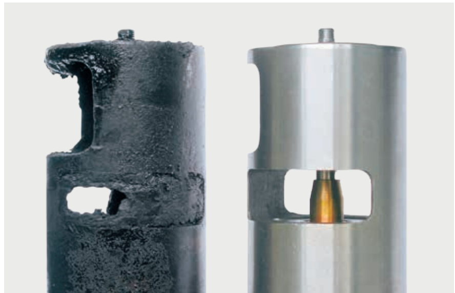
Soupapes EGR encrassée et à l'état neuf
