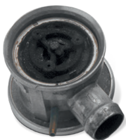
Škody způsobené kondenzátem spalin
