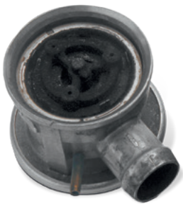
Egzoz gazı yoğunluğundan kaynaklı hasar
