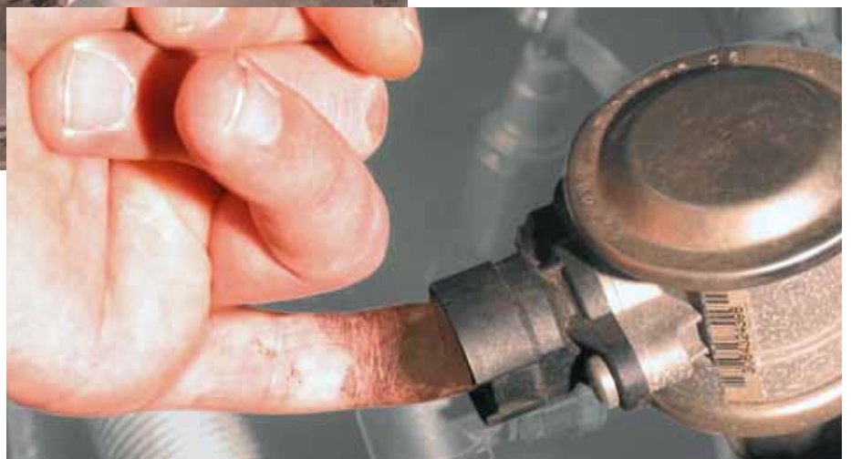
Snabbkontroll på sekundärluftventil i BMW 520i (markerad)
