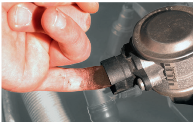
Verificação rápida da válvula de ar secundário em um BMW 520i (em destaque)
