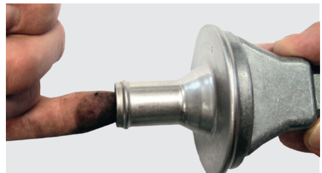
Fig. 1: Simples verificação da válvula de retenção
