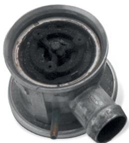
Uszkodzenie spowodowane przez skroplone spaliny
