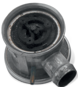
Schaden durch Abgaskondensat
