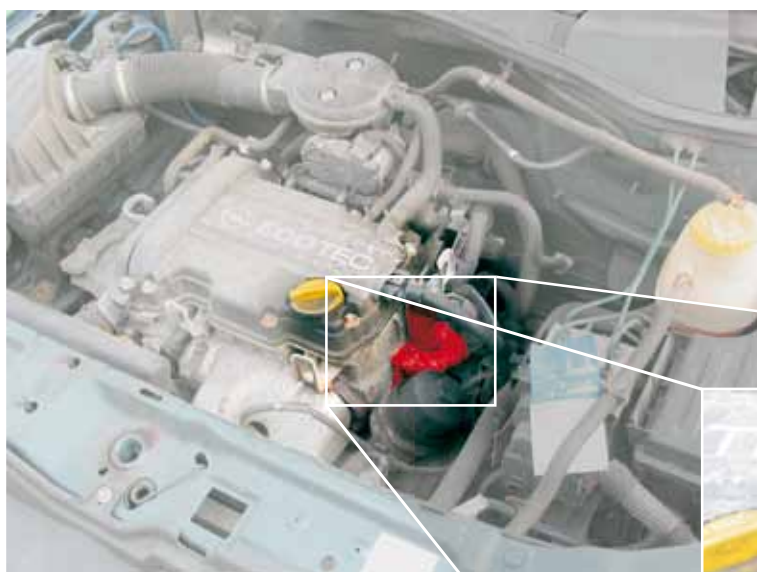
Elektrisk EGR-ventil i Opel-Corsa (markerad)
