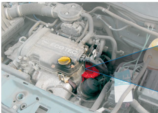
Elektromos EGR szelep Opel Corsa autóban (kiemelve)
