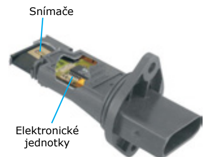
Snímač hmotnosti nasávaného vzduchu s horkým filmem. (novější typ, průřez)
