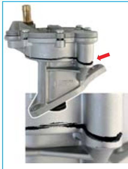
Fig. 1 Prasklé těleso čerpadla
