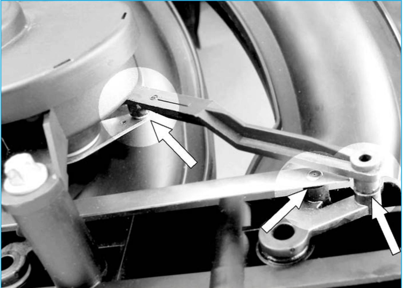
Puntos de conexión entre el EAM-i y las tapas de remolino
